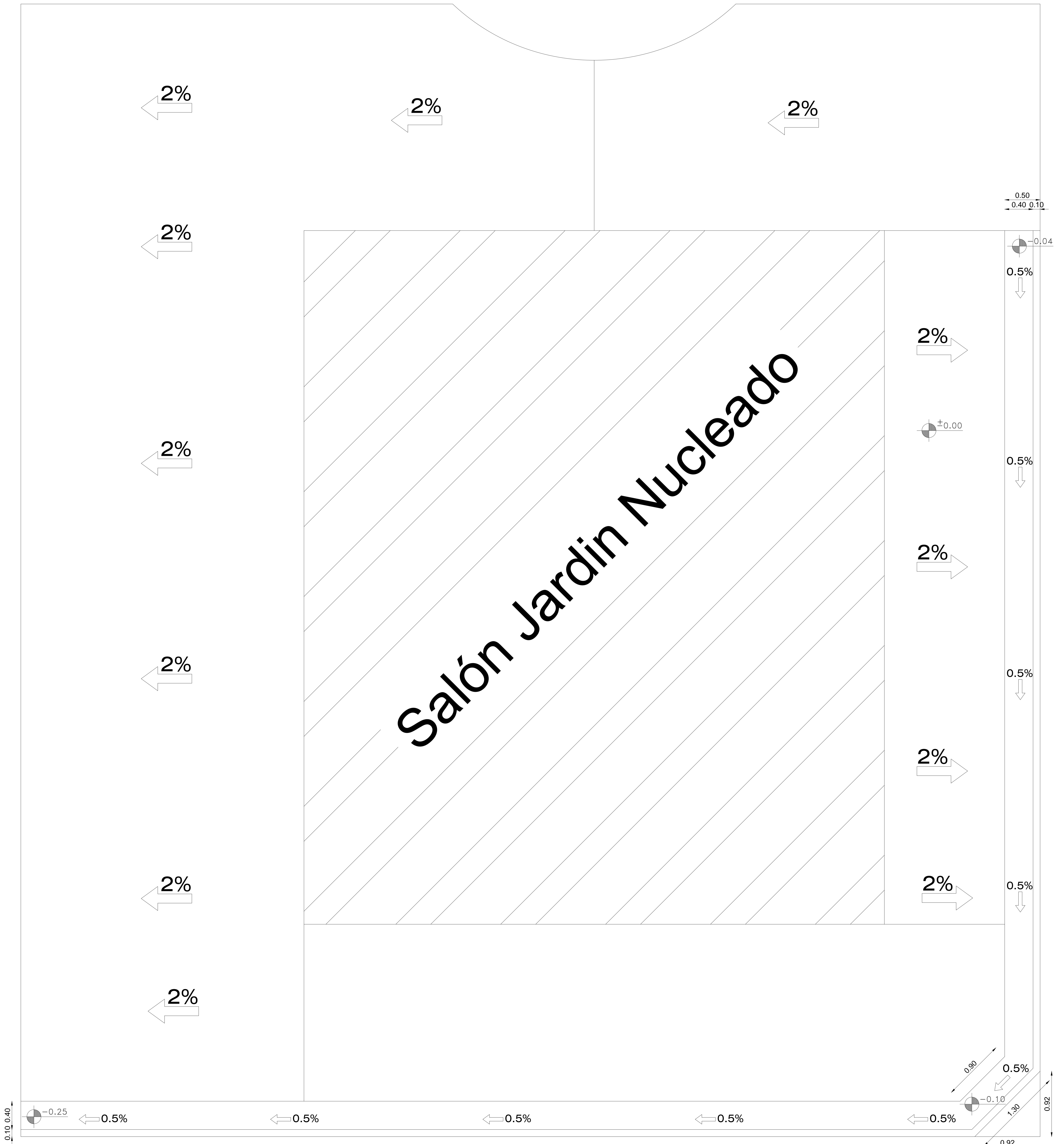
PLANTA DETALLE DE MEDIA CAÑA Y PENDIENTES
