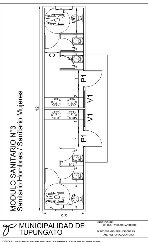
OBRA: ADQUISICIÓN DE CONTENEDORES MÓDULOS SANITARIOS
